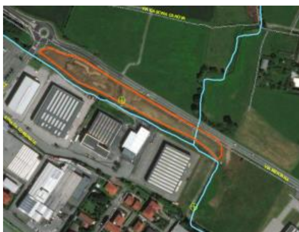
Figura 26 - Opere idrauliche realizzate (in rosso l'area golenale; in verde le griglie)
