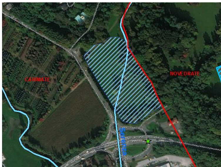
Figura 29 - Tombamento del Torrente Serenza nel Comune di Carimate con criticità in caso di piene (in blu l'area allagata)
